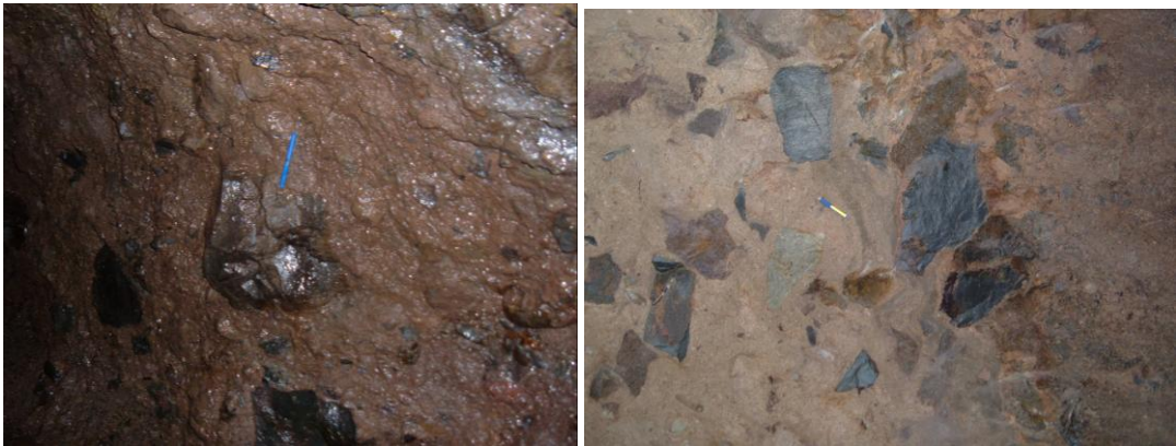
Figura 44. Capa de mortalón sobre la que circula agua subterránea y capa de mortalón seca. CIATF.
